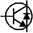
Alcuni transistor, in particolare i transistor di deflessione per tubi catodici e alcuni grossi Darlington sono dotati di protezione interna a diodi, connessa tra collettore ed emettitore. Il Philips BU505DF è un tipico esempio di transistor bipolare con
