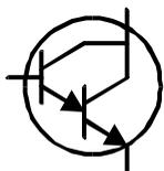
Se fosse rilevato ad esempio un transistor Darlington NPN, lo strumento visualizzerebbe il messaggio riportato di seguito:
